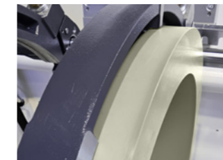
Industrierausführung – Optional sind die Grundmaschinen (250, 315, 355, 500, 630) auch in Industrierausführung mit modifizierter 3. Spannbacke zum Spannen von kurzschenkligen Formstücken sowie Flanschen erhältlich. 2)
