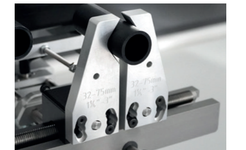
Sattel-Klemmen ohne Absatz, zum Spannen von geraden Formteilen
